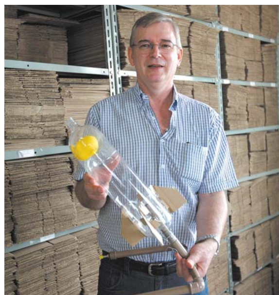
Exemplo de foguete construído com garrafa PET e bola de soprar, montado sobre base de PVC
